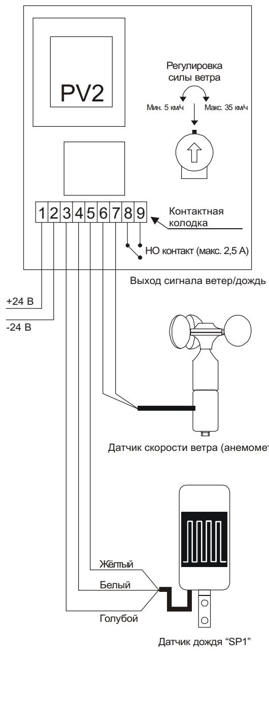
Метеостанция PV2 с напряжением питания =24 В применяется для экстренного управления автоматикой окон (закрывания) в случае начала дождя или усиления порывов ветра.
